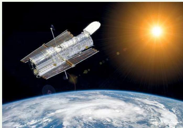
**Fig. 4** El telescopio espacial Hubble mantiene una órbita circular alrededor de la Tierra desde hace 31 años. Su espejo primario tiene un diámetro de 2.4 metros.
