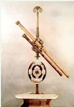
**Fig. 2** Galileo Galilei construyó su propio telescopio de refracción, con lente convexa delante y una lente ocular cóncava.
